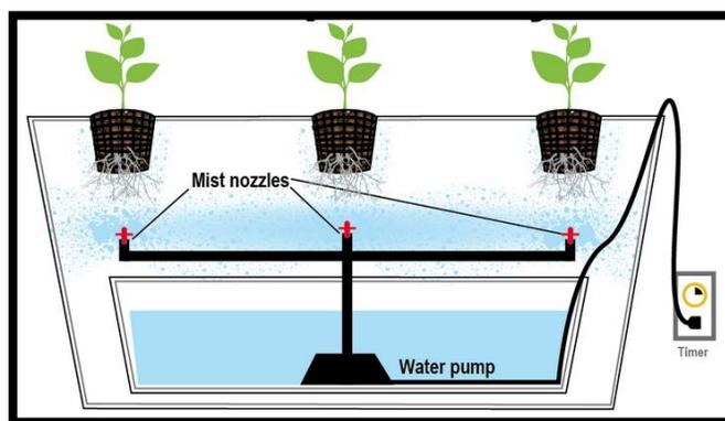
**Fig2.5.1. Aeroponic System**
